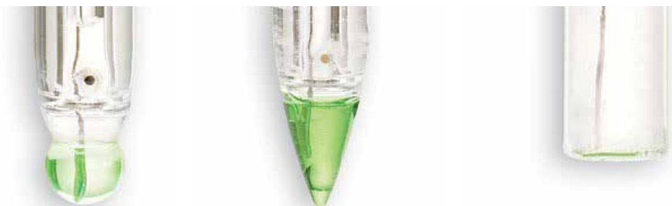
Esempi di punte: a sfera (a sinistra), conica (al centro) e piatta (a destra).
